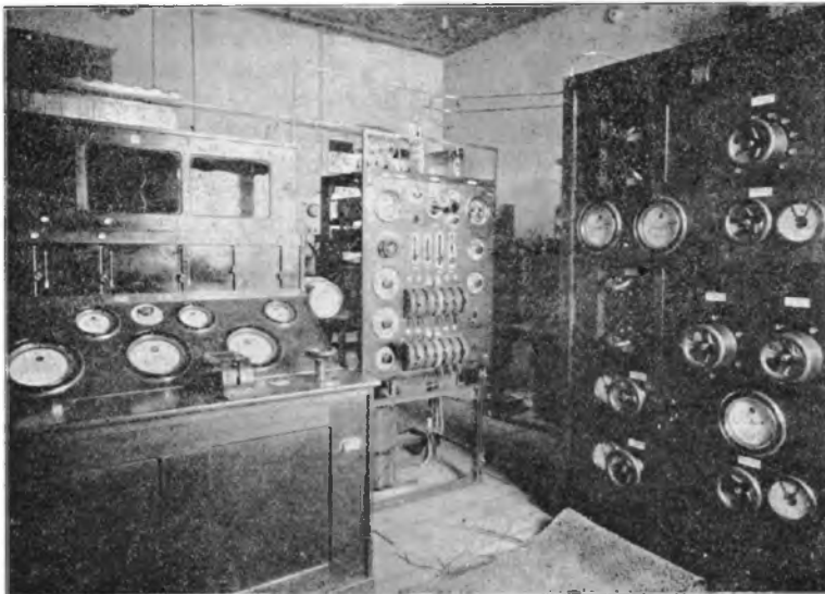
Fig. 2. De 5 K.W. Telefunken-zender te Scheveningen-Haven.
